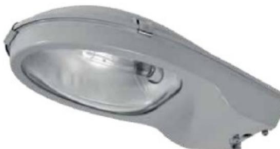
**Descripción:** Fabricado en Aluminio fundido a presión. Reflector de Aluminio, y Cierre mediante cristal templado transparente. Toda la tornillería es de acero inoxidable. Se suministra sin equipo. Las lámparas de sodio y los equipos de doble nivel con línea de mando, ahorran hasta un 40% de consumo energético.
