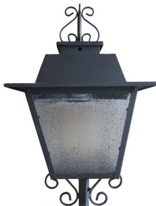
**Descripción:** Fabricado en Chapa de Aluminio y pintado en color negro. Bajo demanda se puede pintar en cualquier color de la gama RAL. Cuerpo superior con capacidad para alojamiento de Equipo. Fijación mediante cogida o adaptador para columnas terminadas en punta. Soporta tanto portalámparas E-27 como E-40. Está fabricado conforme a UNE-EN 60598. Soporta Grupo Óptico IP-65, según normativa vigente.
